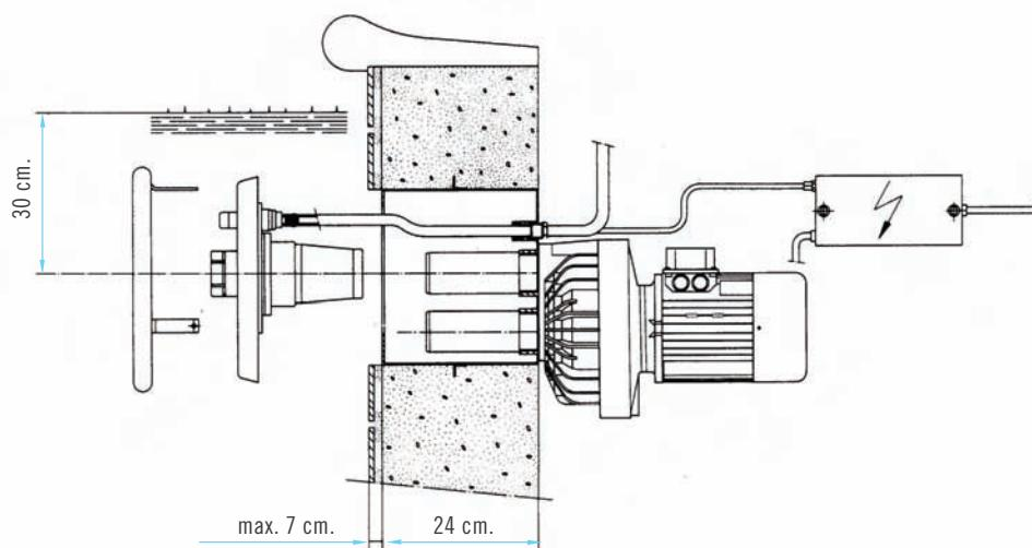
El montaje del conjunto de impulsión admite una compensación del acabado superficial de la piscina de hasta 7 cms. con respecto a la caja-alojamiento.
